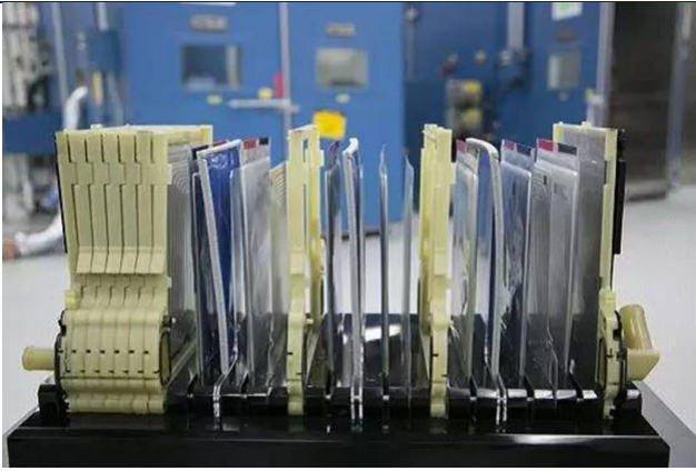
图 36、通用 Bolt 采用软包电芯
