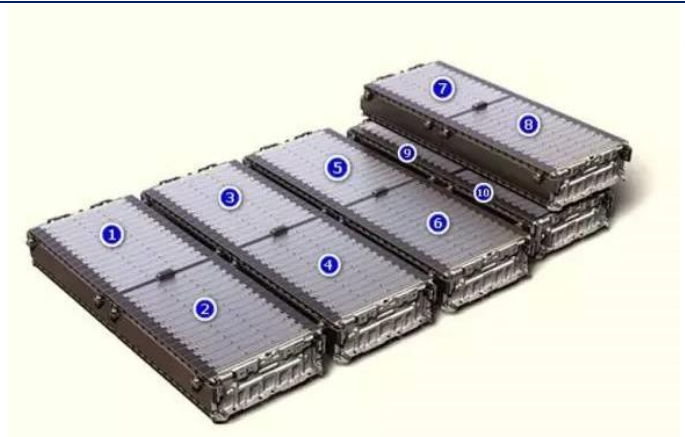
图 37、Bolt 电池包位于车身底盘，属于典型的滑板式
